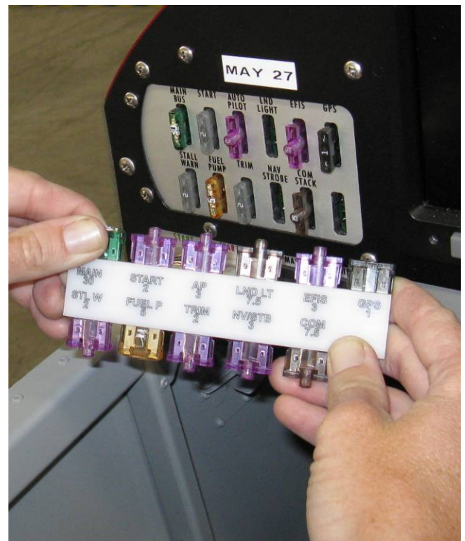
D180 FUSE PANEL
